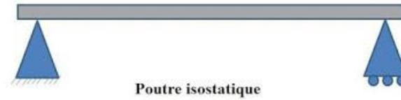
**Figure I-1-Poutre Isostatique**
