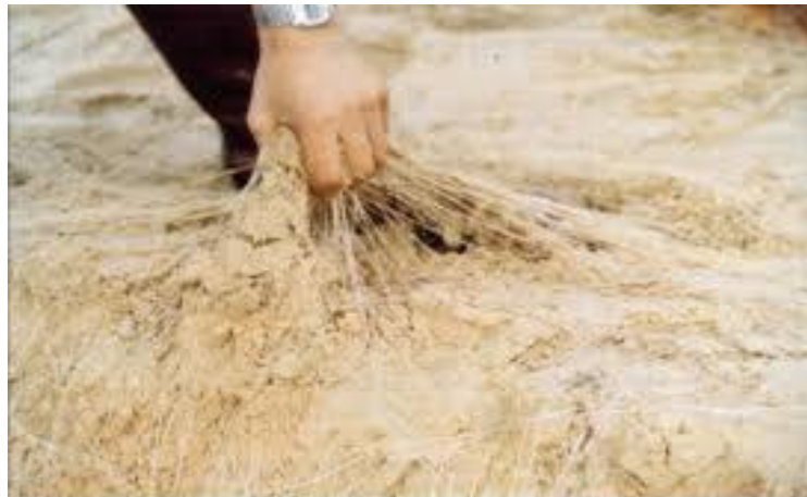
Figure 2. 4 La nouvelle technologie de tex sol [8]
