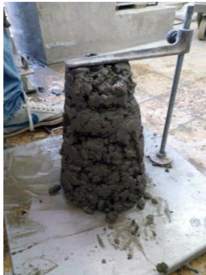
**Figure 2.9 :** Essai d'affaissement au cône d'Abrahms.
