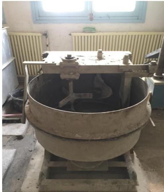
**Figure 2. 5 :** Malaxeur à béton utilisé.
