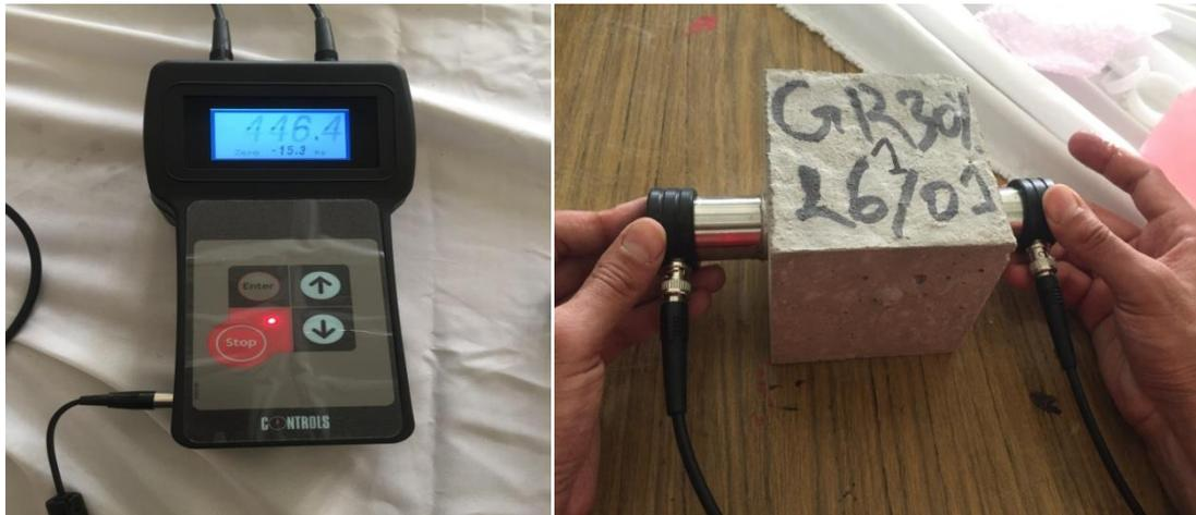
**Figure 2.12** : Essai ultrasonique (controls).
