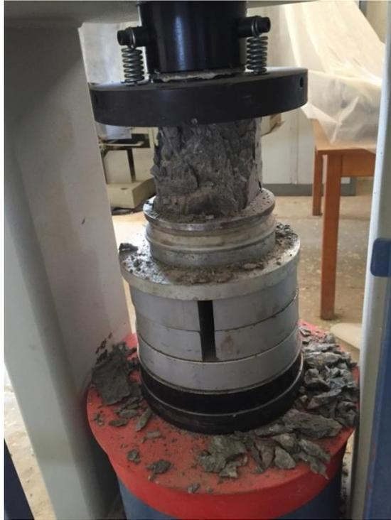
Figure 2.10 : machine d'essai de compression.
