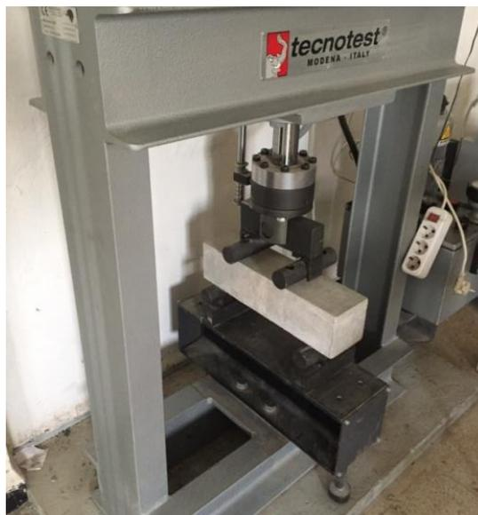
Figure 2.11 : Machine d'essai de flexion à 4 points.
