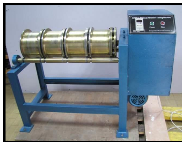
Figure 7.10 Appareillage de l'essai Micro Deval
