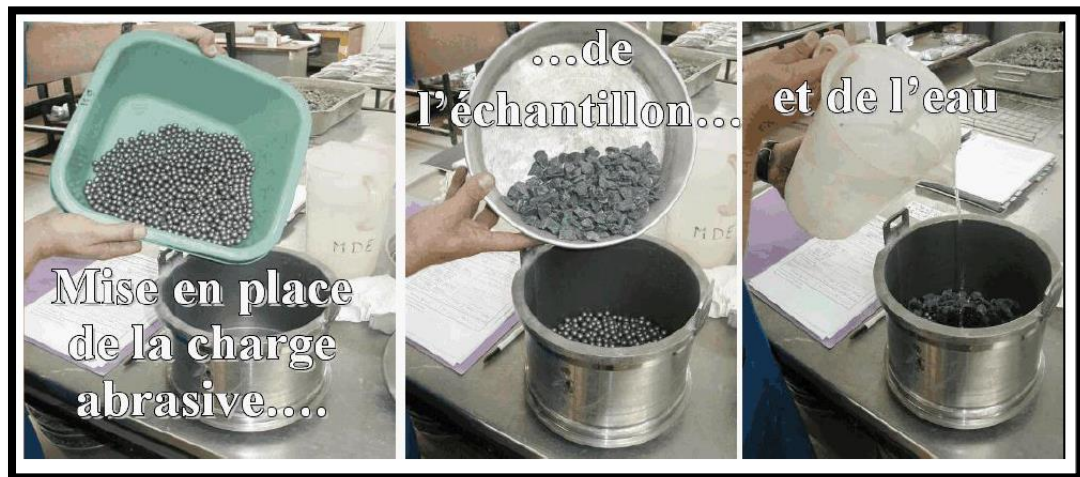
Figure 7.9 Mode opératoire de l'essai Micro Deval
