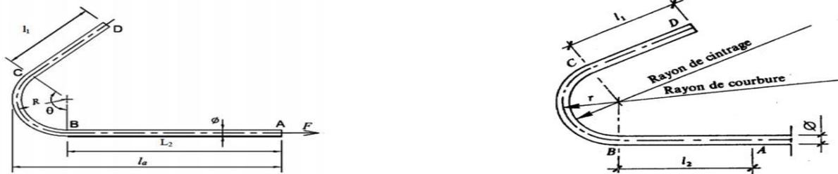
Figure II.3: Définition d'un ancrage courbe
