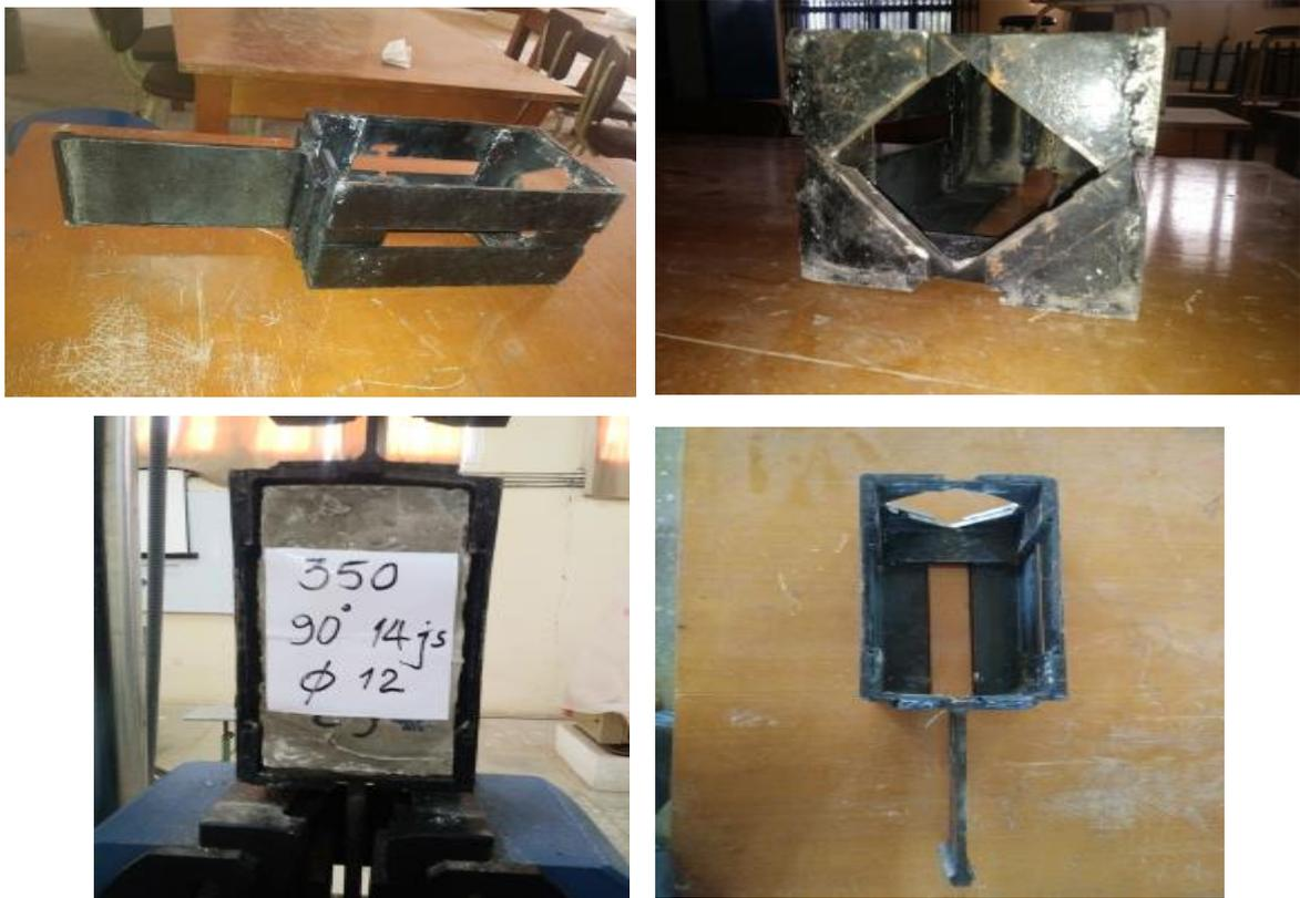
Figures III.11 : le cube d'acier contenant l'échantillon dans la machine
