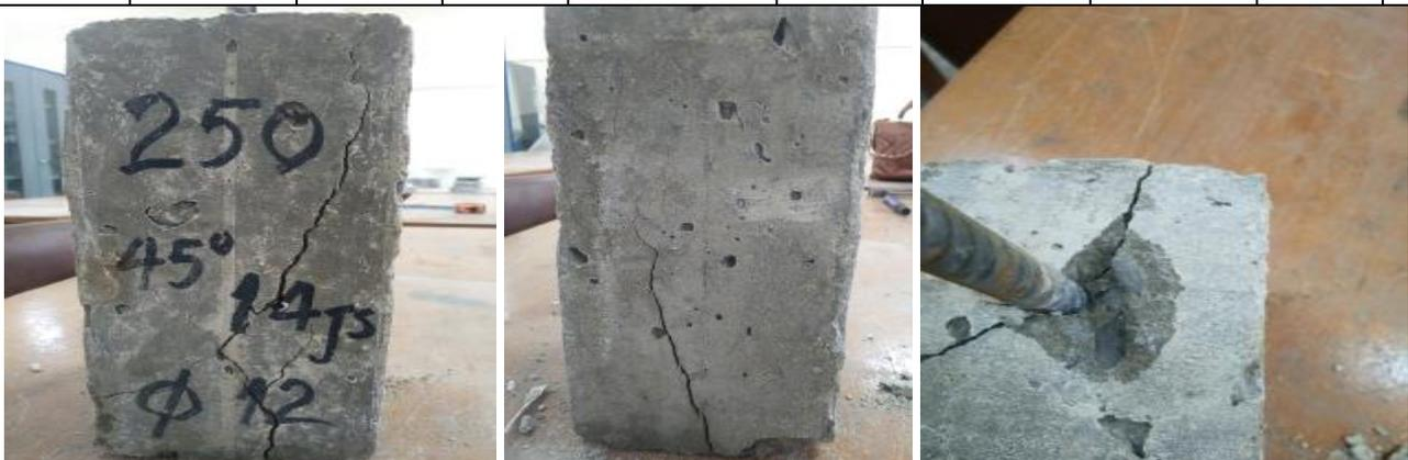
Figures III.13 : exemple d'une éprouvette à l'âge de 14 jours Après l'essai d'arrachement
