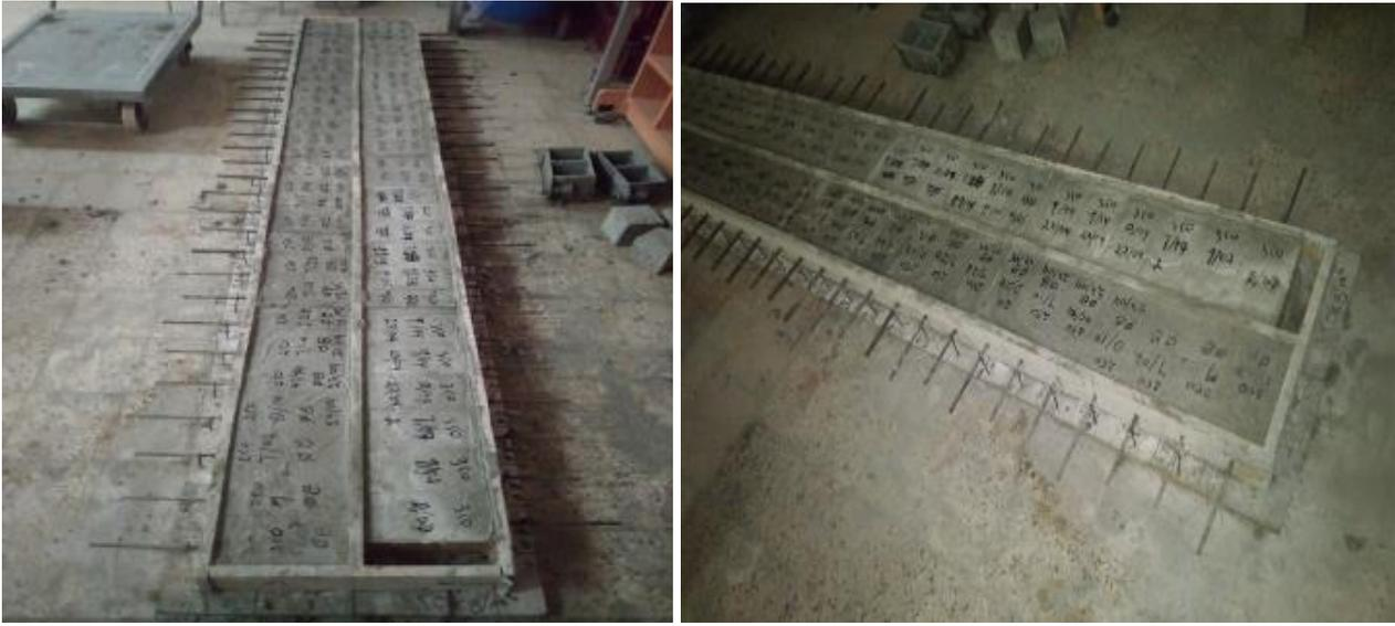
Figures III.7 : les éprouvettes après 24H
