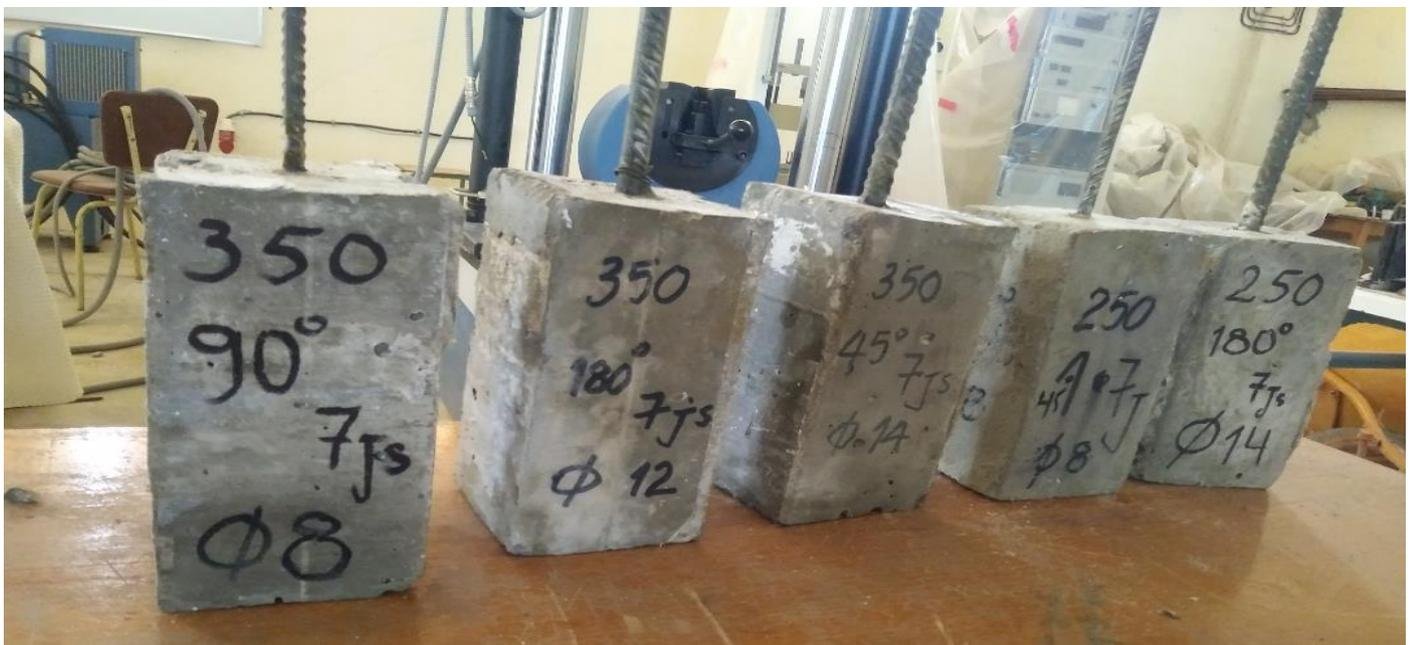
Figure III.6 : Eprouvettes cubique (20x10x10) cm
