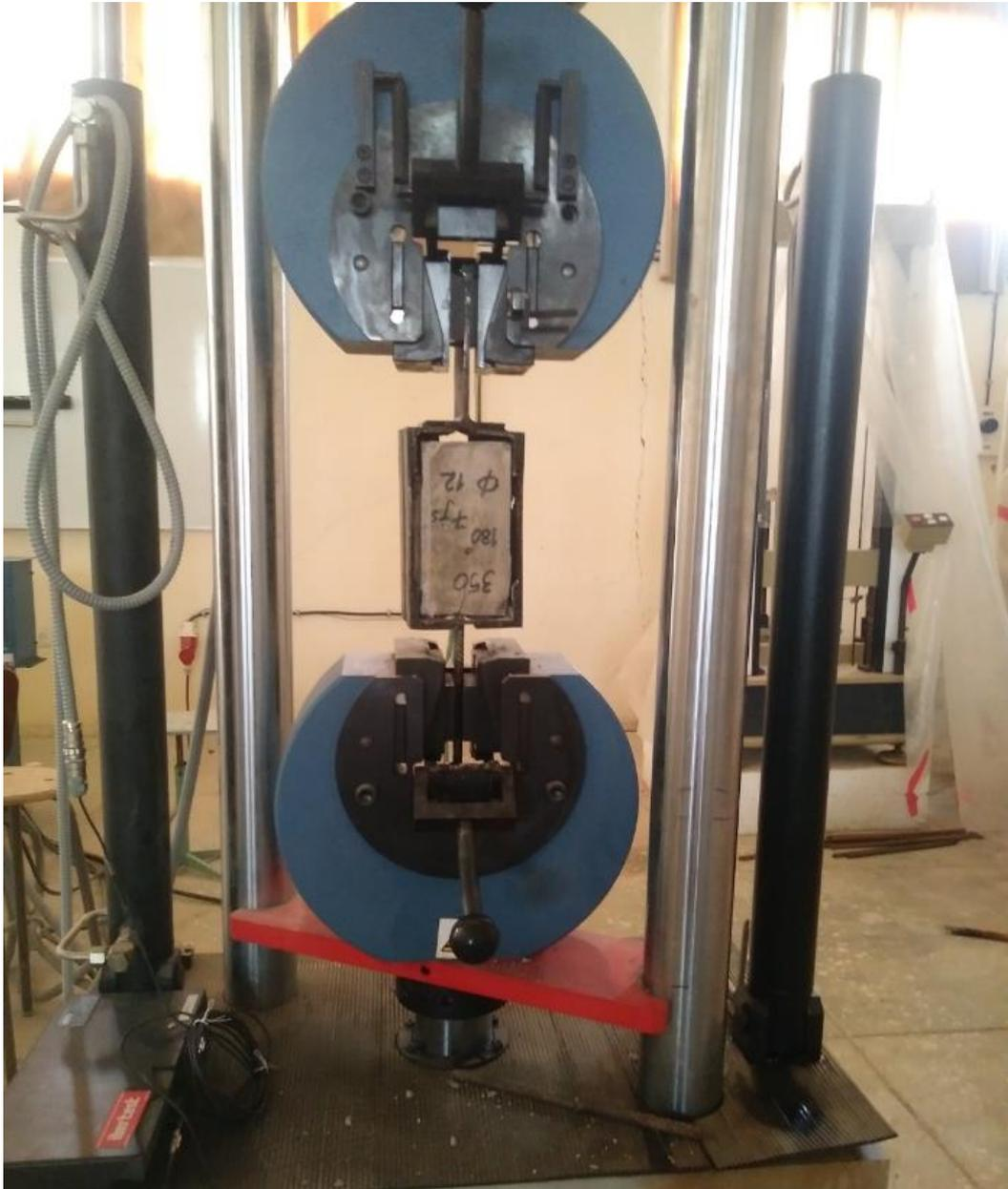
Figures III.8 : La machine de traction
