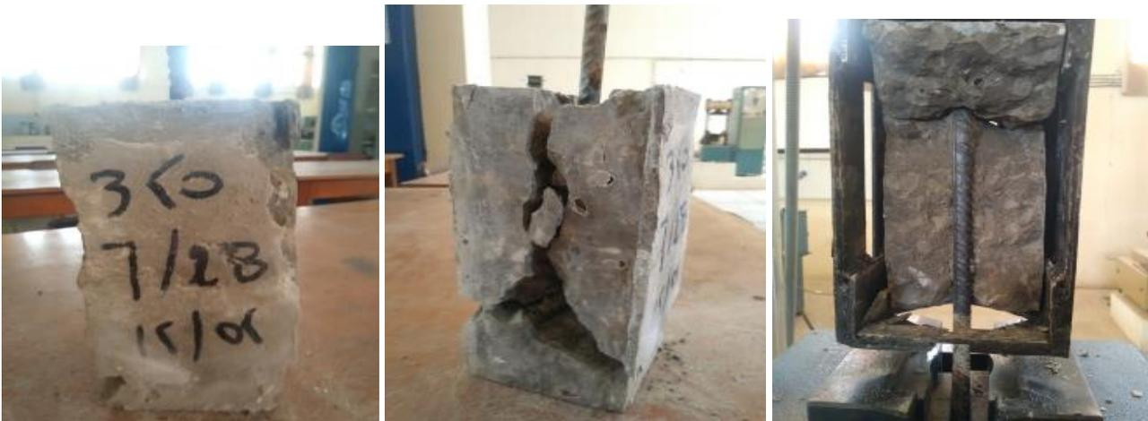
Figures III.14 : exemple d'une éprouvette à l'âge de 28 jours Après l'essai d'arrachement
