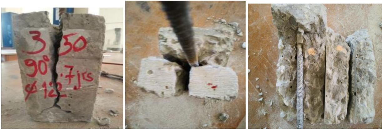
Figures III.12 : exemple d'une éprouvette à l'âge de 7 jours Après l'essai d'arrachement
