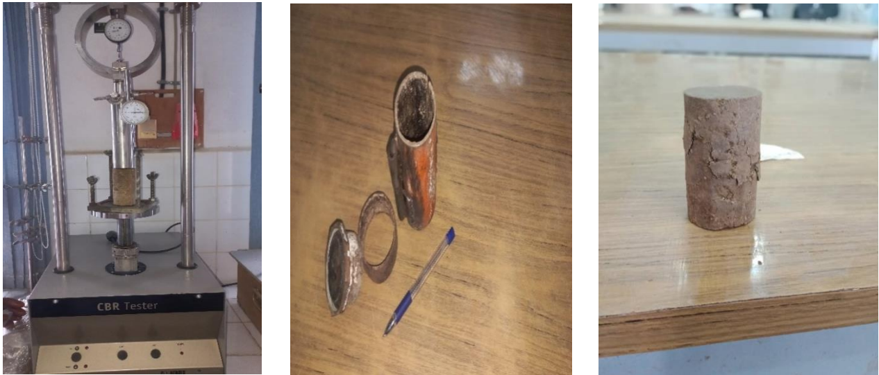
Figure 5.36 La préparation des éprouvettes et rupture des échantillons et l'écrasement avec CBR tester.
