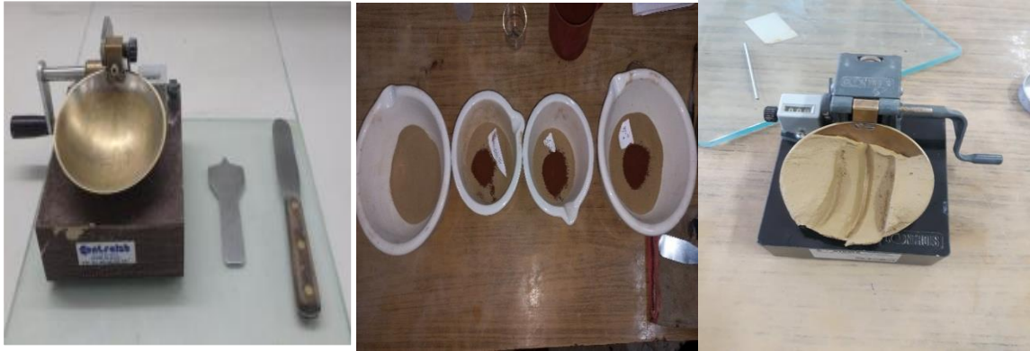
Figure 5.6 Appareil de Casagrande et échantillon préparé.
