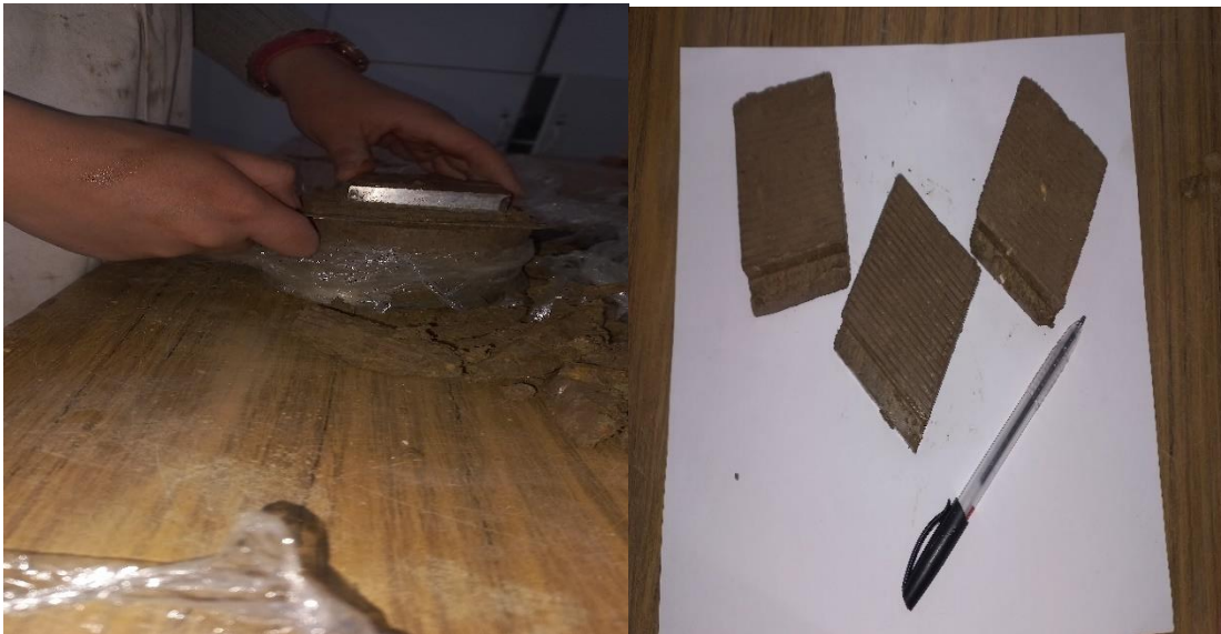
Figure 5.61 Préparation et résultat d'essai de cisaillement.
