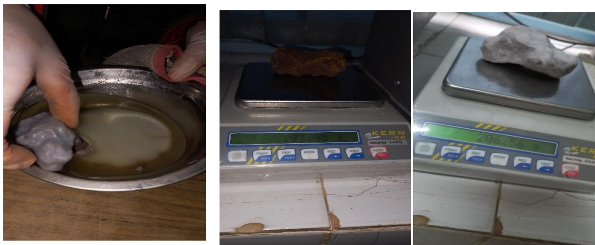
Figure 5.1 les étapes de paraffinée l'échantillon.
