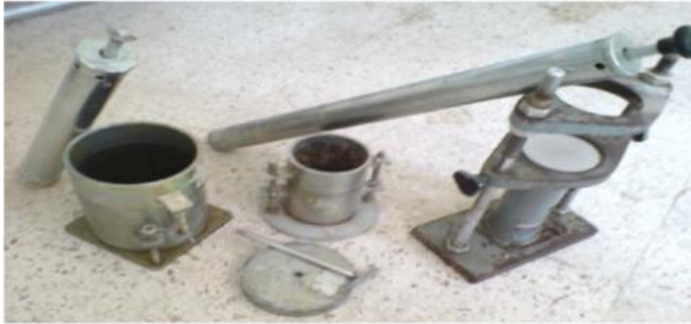
Figure 5.20 Appareillage spécifique pour l'essai Proctor.
