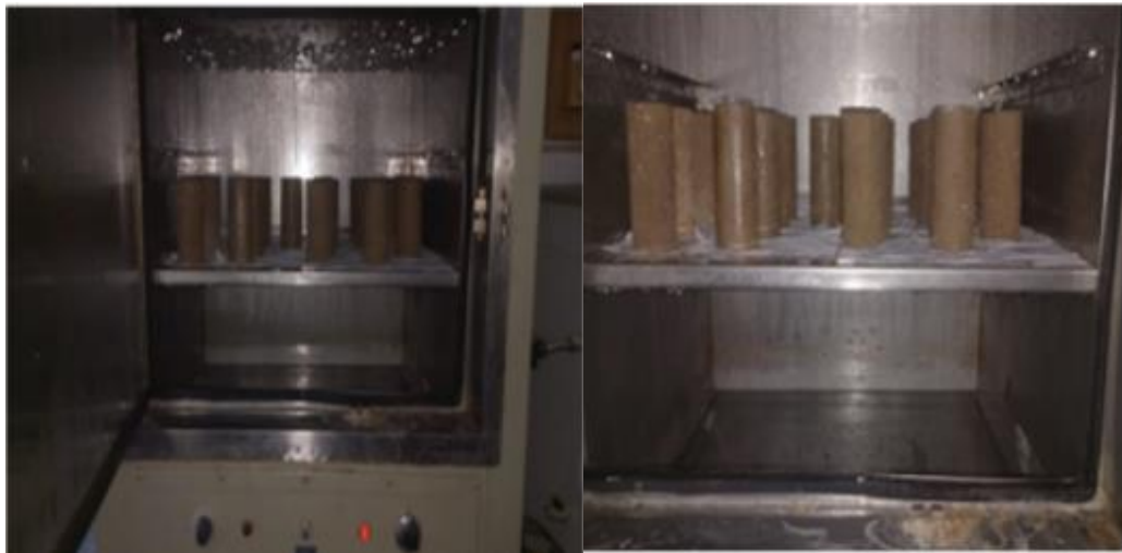
Figure 5.30 Les échantillons dans l'enceinte climatique.
