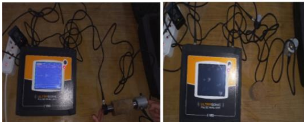
Figure 5.31 Temps des ondes ultrasoniques sur des éprouvettes.
