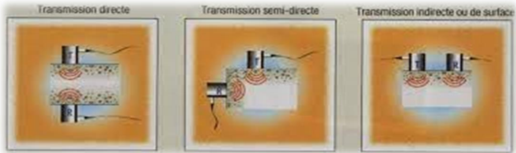
Figure 5.29 Type de propagations d'ondes [44].
