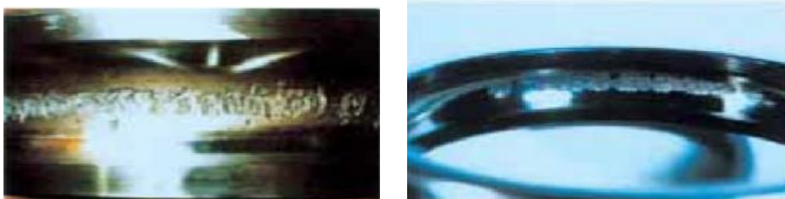
Figure IV.4 : L'écaillage des pistes.
