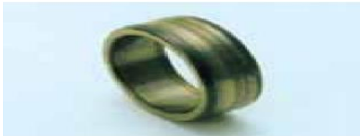
Figure IV.12 : Usure (modification de la précision géométrique).
