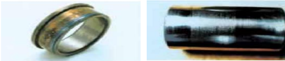
Figure IV.9 : Usure et grippage.
