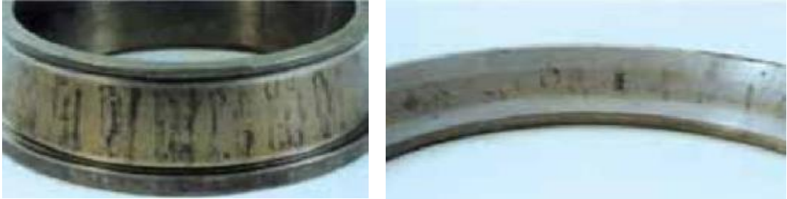
Figure IV.10 : Corrosion des pistes.
