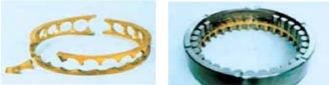
Figure IV.7 : Détérioration de cage.
