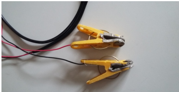
Fig. II.12 : Image des électrodes réalisées.
