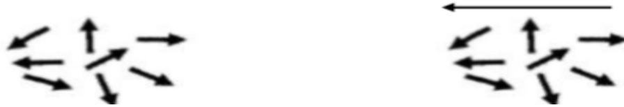
Figure I- 5: Polarisation avec champ électrique et sans champ électrique E
