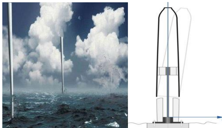
Figure 2.9: éolienne sans pales [35].
