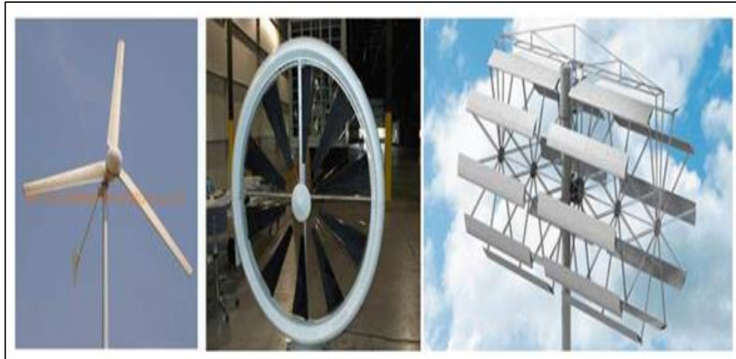
Figure 2.5 : Les différents types d'éolienne à axe horizontal.
