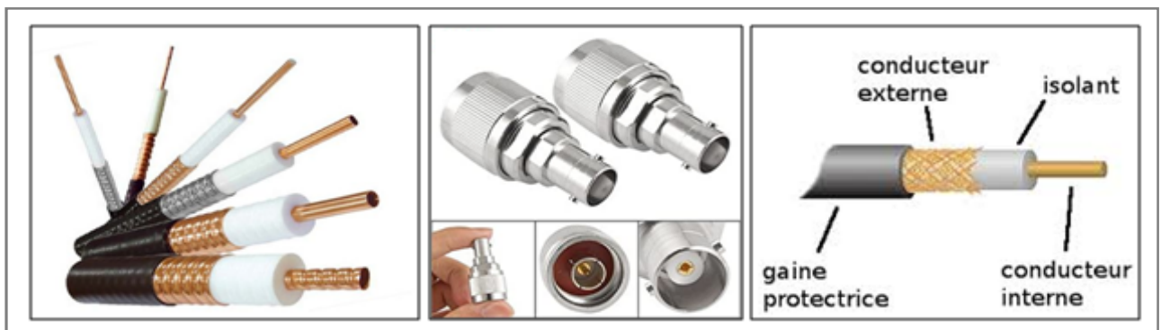
Figure(2): Les Câbles coaxiaux
