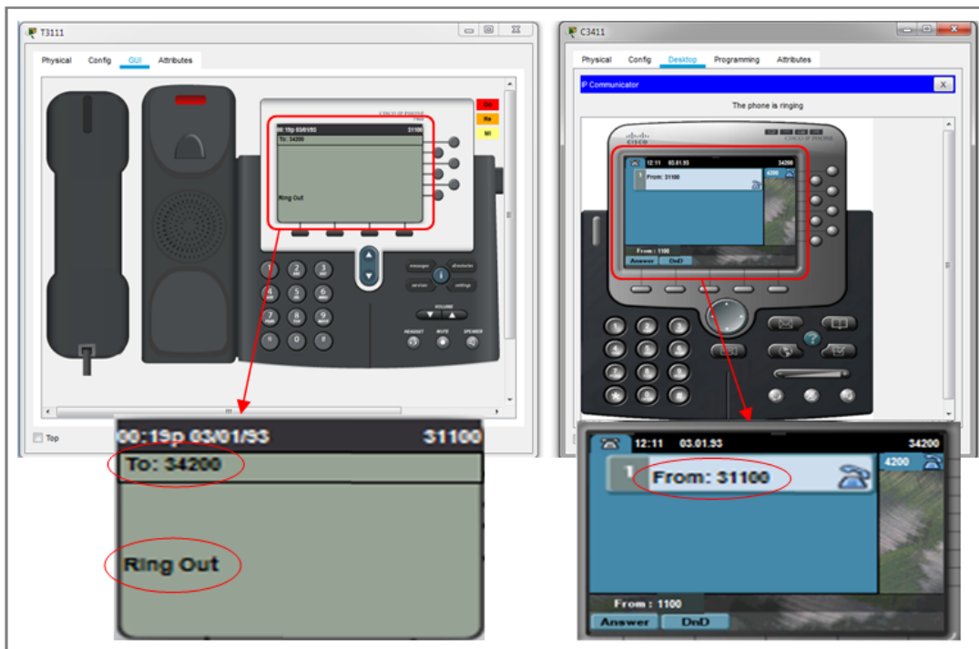
Figure(26): Simulation d'un appel VoIP entre un IP-Phone et Soft-Phone
