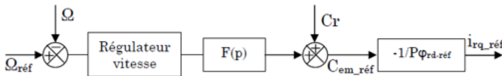
Figure (2.6) : Boucle de régulation de la vitesse.
