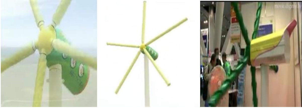
{الشكل 3.4} عنفة هوائية نوع ماغنوس
