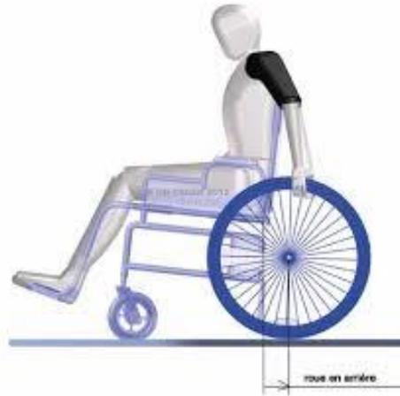
**Figure I.3 :** Chaise roulante à propulsion manuelle.
