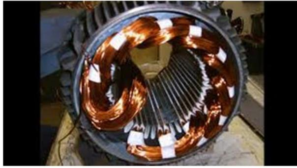
**Figure II.10** : bobinage d'un moteur BLDC
