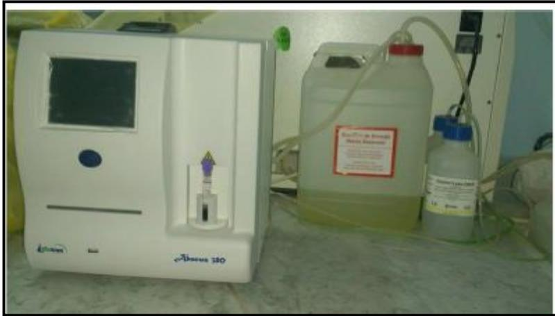
Figure13: Un automate d'Abacus 380 à 19 paramètres
