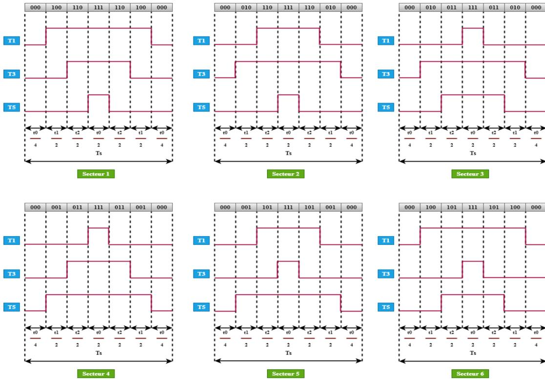
**Figure 2.20** Représentation des séquences de conduction des interrupteurs.
