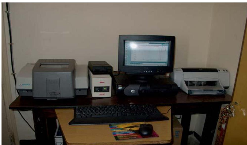
**Figure 2.7** : Spectromètre à transformée de Fourier de type Nicolet (Avatar 360 N) utilisé pour la caractérisation FTIR.
