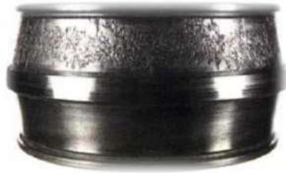
Figure III-8 : Défaut de roulement – Ecaillage.
