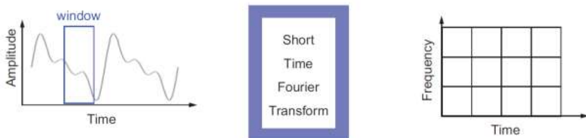
Figure II-3 : La Transformée de Fourier à fenêtre glissante [61].
