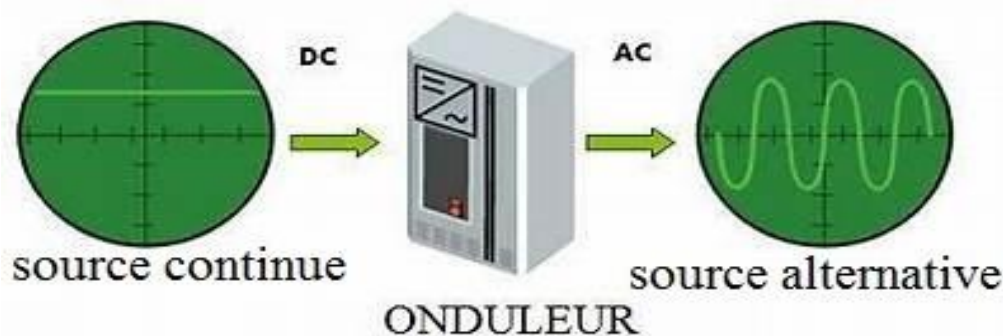
Figure I.14 Schéma de principe de la conversion Continu - Alternative (DC – AC)
