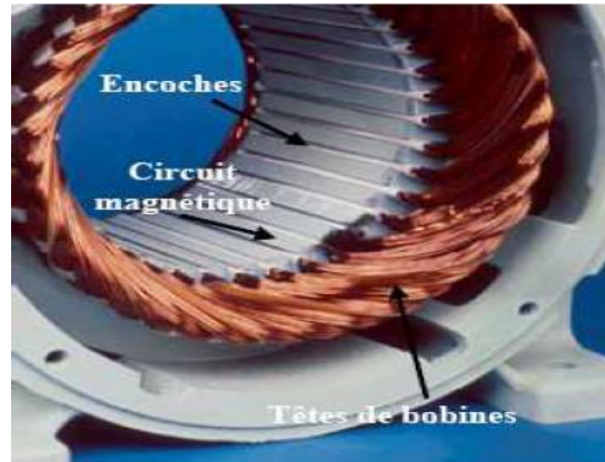
Figure I.2 Photo du stator d'une machine asynchrone
