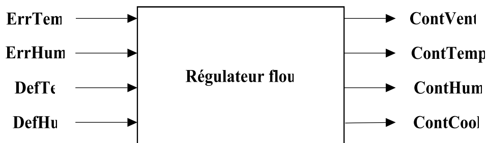
Fig II. 19. Régulateur flou de la température et d'humidité avec système de refroidissement.
