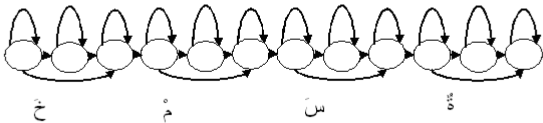
Fig. 4-5 : Concaténation de modèles de phonèmes pour le mot "خنسة"
