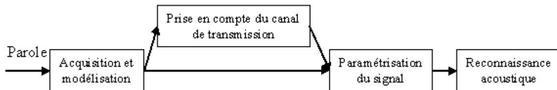
Fig. 2-3 : chaîne de traitement acoustique d'un système de reconnaissance de la parole
