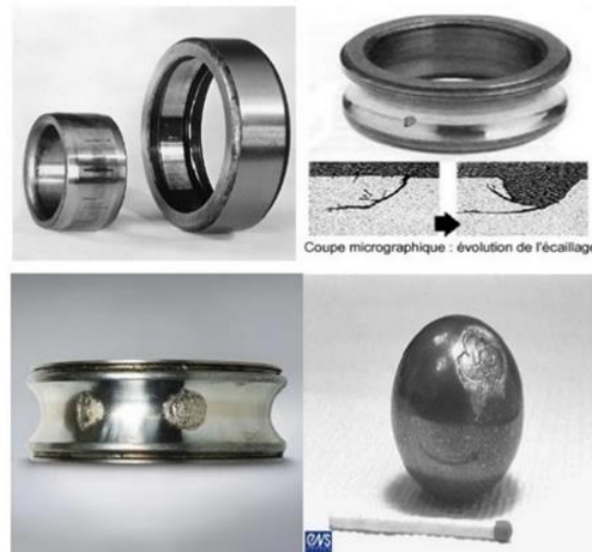
Figure I-24: Défauts de roulements.
