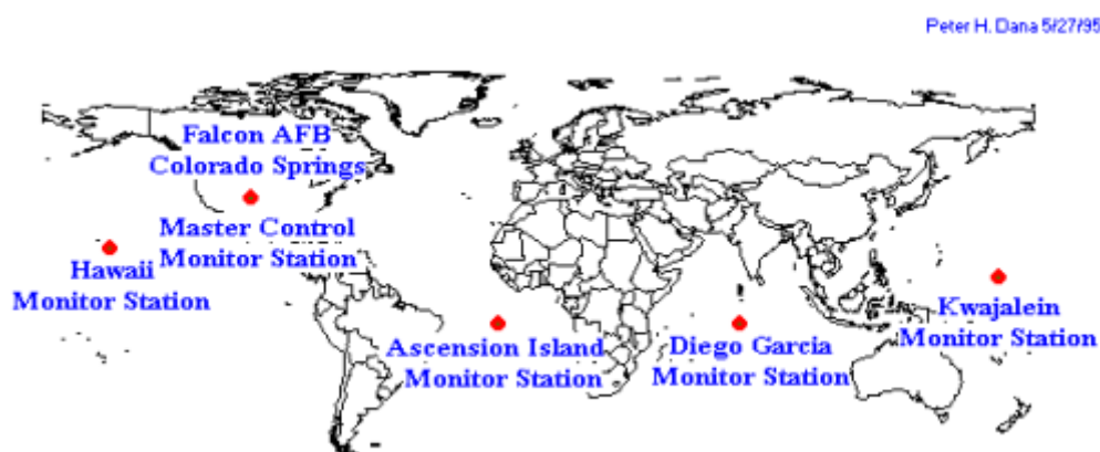
Figure I.3 : Contrôle principal du système de positionnement global (GPS) et réseau de stations de surveillance.
