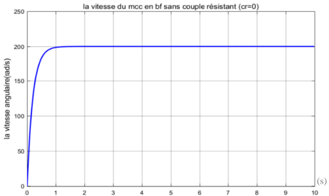
Figure II-28 : Réponse indiciale de vitesse en BF sans charge.
