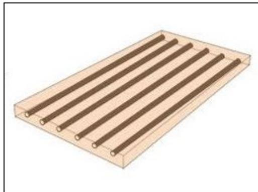
**Fig. I.16** Pli unidirectionnel
