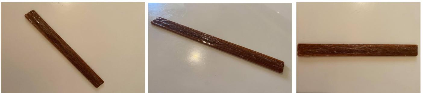
**Fig. 3.20** Eprouvette élaborée sisal/Epoxyde
