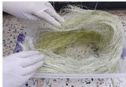
**Fig. 3.9** Immersion des fibres de sisal dans la solution de soude
