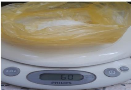
**Fig. 3.8** Préparation de la solution de soude (NaOH) à 2%
