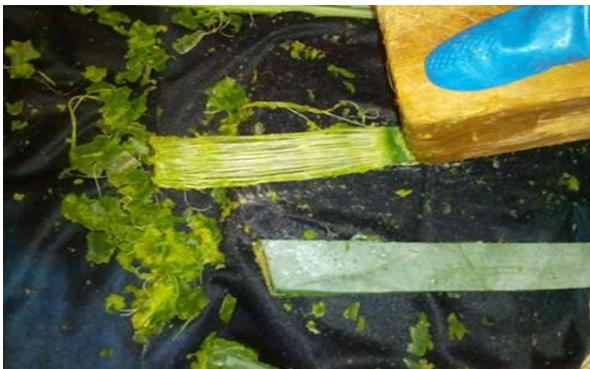
Fig. 3.4 Ecrasement des fibres lame de sisal
