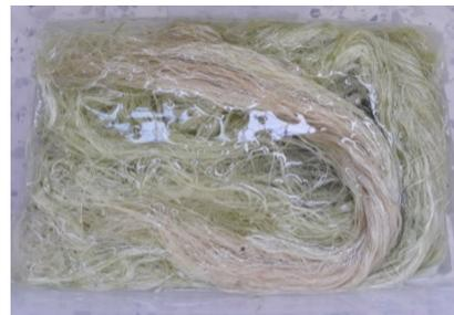
**Fig. 3.11** Immersion des fibres de sisal dans L'eau distillée pendant 15 min
