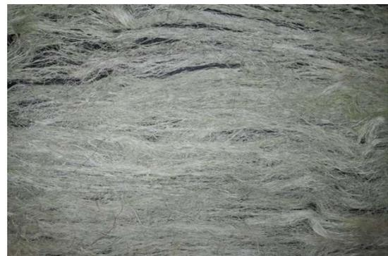
Fig. 3.7 fibres de sisal après séchage
