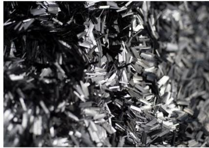
**Fig. 1.7** Fibres acryliques élaborées à partir du poly acrylonitrile (PAN)
