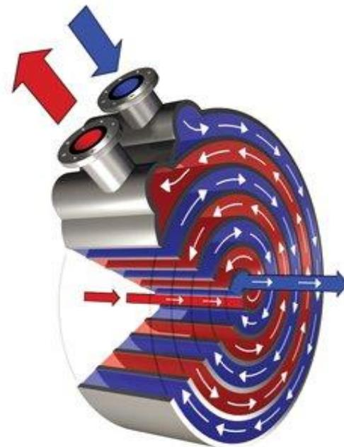
**Figure (I.13) :** Échangeur à plaque en spirale. Les deux fluides circulent en contre-courant.
