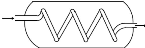
**Figure (I.8) :** Échangeur monotube.
