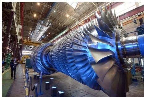
*Figure I.17 une grille d'aube de turbine*
