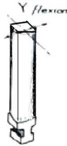
*Figure III.5 la flexion suivant l'axe y (poutre)*
