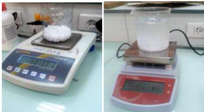
(Fig. II.14) Préparation de solution NaOH : a) NaOH et b) Dissolution de NaOH dans l'eau distillée [20]
