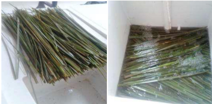
Fig. II.16 Fibre de DISS : a) avant immersion dans la solution NaOH et b) après immersion dans la solution NaOH [20]
