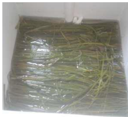
Fig. II.17 Tige de DISS après traitement [20]
