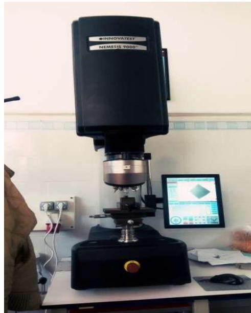
Figure 4.18 : Appareils de mesure de dureté au niveau de CRTI .
