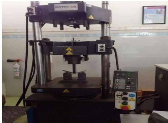
**Figure 4.20:** Machine d'essais de pliage (CRTI)
