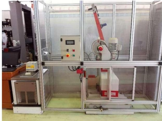
**Figure 4.17:** Machine d'essais de résilience au niveau de CRTI .
