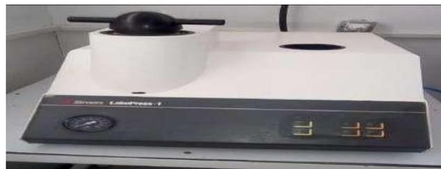
**Figure 4.10 :** Enrobeuse au niveau de CRTI..
