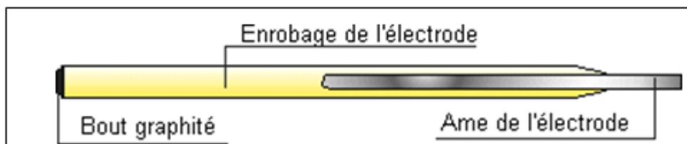
**Figure 1.6:** Composant de l'électrode enrobée [11]
