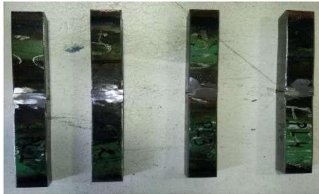
**Figure 4.19:** Eprouvettes de pliage..
