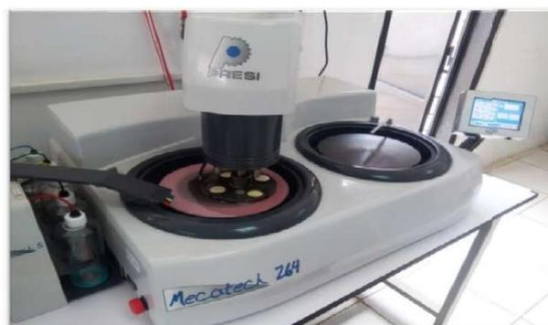
**Figure 4.12:** Polisseuse au niveau de CRTI..
