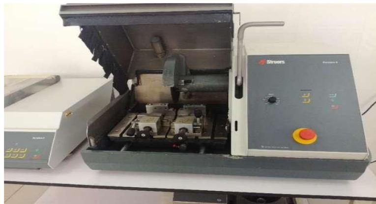
**Figure 4.3 :** Une tronçonneuse (Struers Discotom) au niveau de CRTI.
