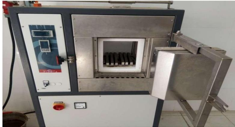
**Figure 4.9 :** Les éprouvettes dans le four au niveau de CRTI [28].
