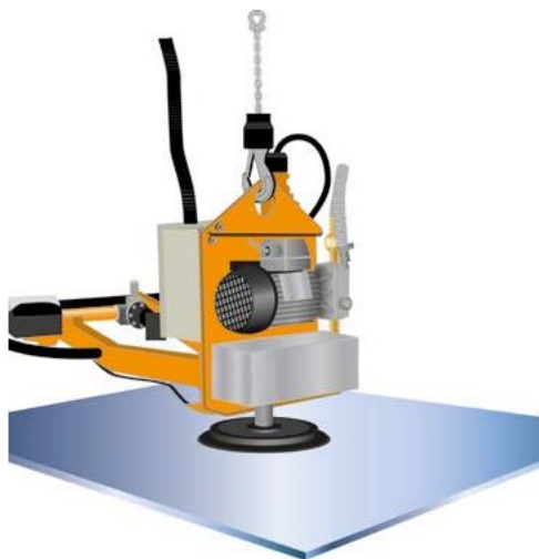
Figure I.16 Levage manutention par le vide
