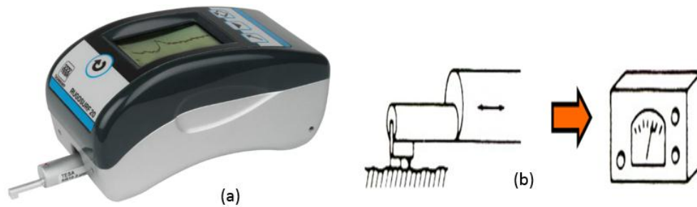
Fig.2.6 : a) appareil de mesure de la rugosité TESA RugoSurf 20, b) Appareils électroniques à palpeur donné le moyenne (R ou Ra).
