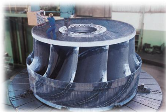
Fig. 1.3 : Tour vertical (usinage d'une turbine hydraulique)
