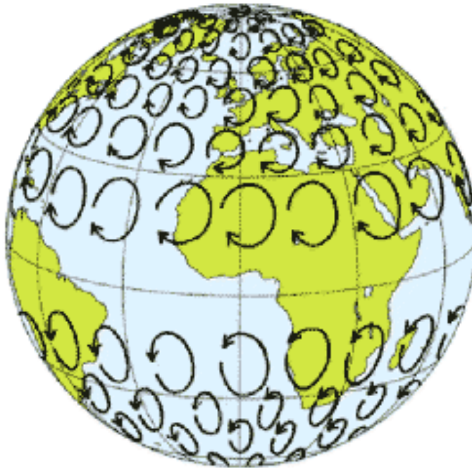
الشكل (03): تأثير قوة كوريوليس على اتجاه الرياح Coriolis
