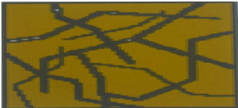
Figure (1.8) : Porosité de fissure
