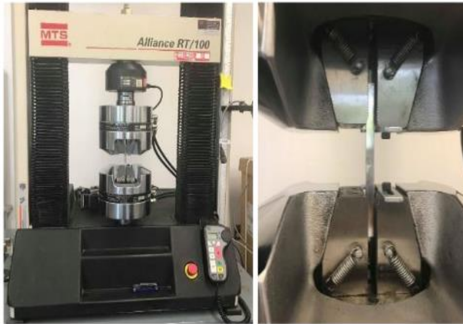
Figure III.41. Presse hydraulique pour les essais de traction [29].
