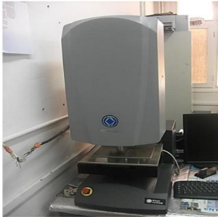
Figure III.15. Micro-duromètre de type WILLSON HARDNESS type TUKON 2500. [21]
