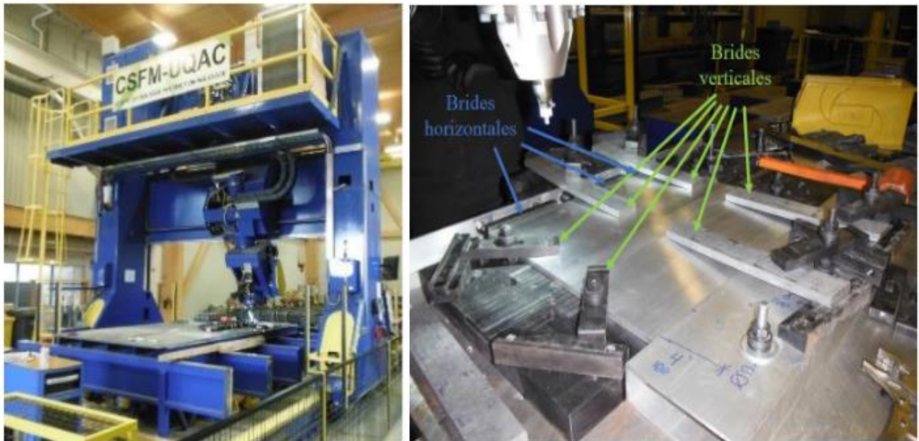
Figure III.32. Banc d'essai du portique spécialisé au CSFM-UQAC [29]
