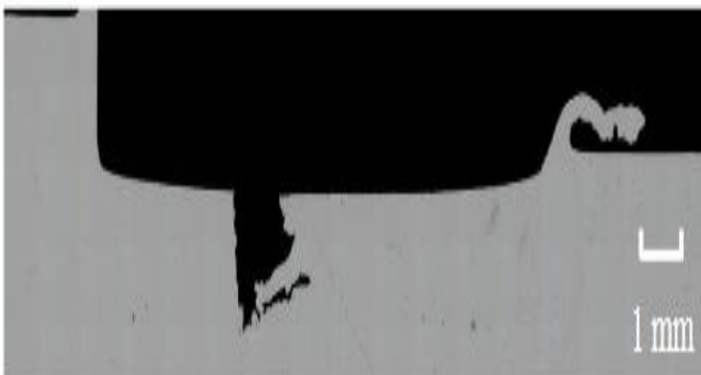
Figure III.51 Section d'un échantillon avec décalage du CA supérieur à 1,0 mm [33]
