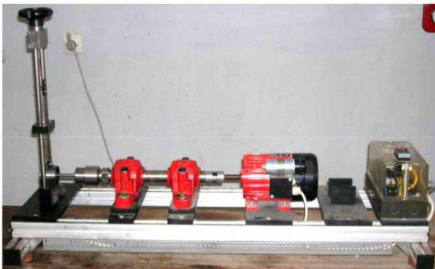
Figure. III.9. Banc d'essais de fatigue : marque WP 140 [21]
