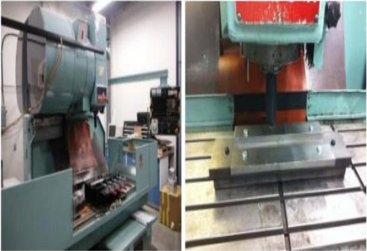
Figure III.34. Banc d'essai de la fraiseuse CNC au Cural [29]
