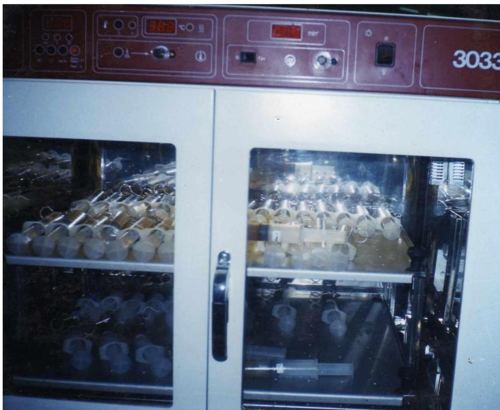
*Figure n°12 : l'incubation dans une étuve à agitation rotatoire (type GFL 3033)*
