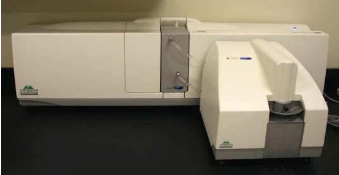
Figures 2.1. Granulomètre laser Mastersizer 2000 de MALVERN.
