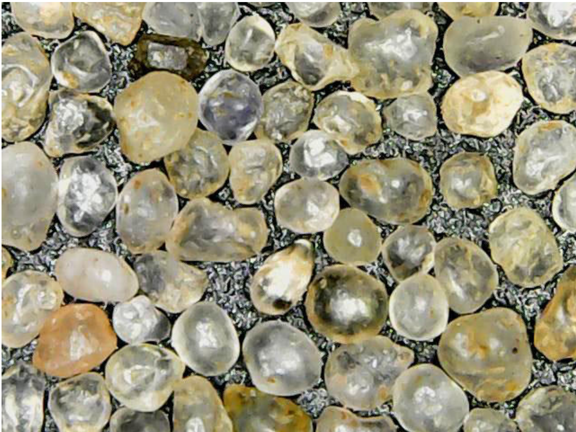
Figure .3.10. Observation à la loupe des grains de quartz en vue de l'étude morphoscopique de la coupe d'El Kouif (Ech 12).
