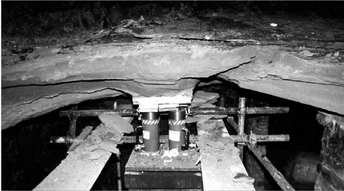
Fig. 85 : Toit de grotte chargé jusqu'à la rupture, dans un test à grande échelle sur un grès homogène à Nottingham, UK (AC. Waltham, 2007).
