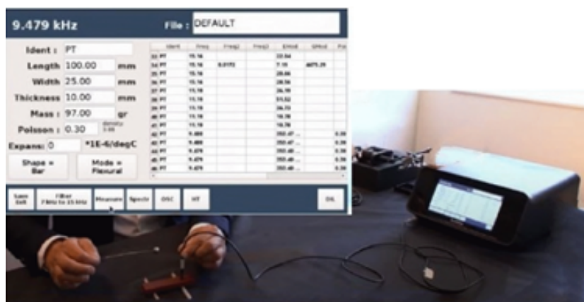
FIGURE 4.3 – Mesure du module de Young (méthode dynamique).
