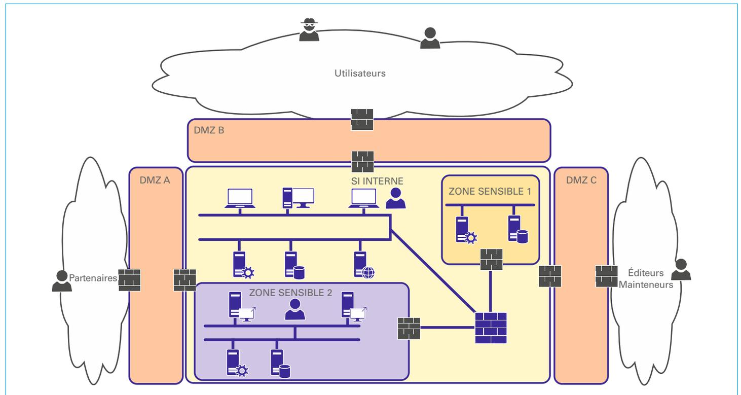
Figure 2 - Représentation d'un modèle d'architecture de type aéroport
