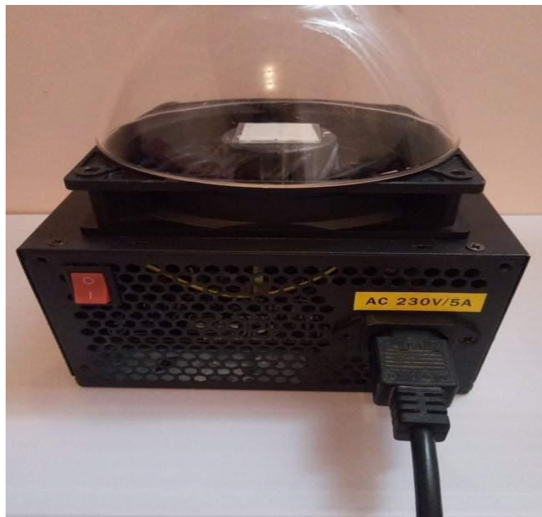
Figure III.2: Dispositif expérimental de spin-coating des couches utilisé au Laboratoire de physique appliquée et théorique, Université Larbi Tébessi - Tébessa.
