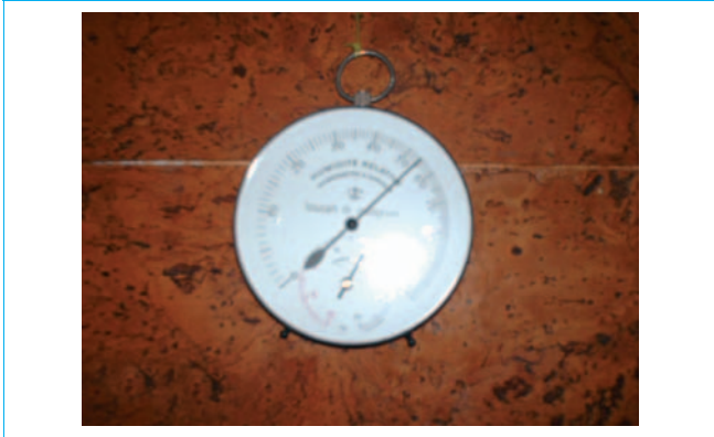
Figure 6 – Hygromètre à cheveu – L'appareil est muni de 2 aiguilles
