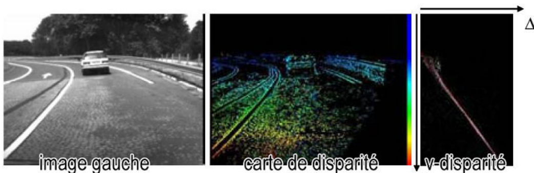
Figure 5.2 : L'approche de Labayrade [Labayrade 02] qui consiste à créer une v-disparité dans laquelle se dessine le profil de la route et des obstacles.
