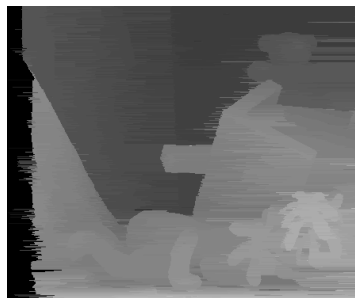
Figure 4.16 : Sur cette carte de disparité on peut aisément constater la propagation des erreurs.
