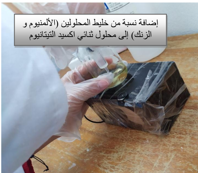
الشكل II.2: يوضح خطوات تحضير محلول TiO_2:5\%wt.Zn\&5\%wt.Al
