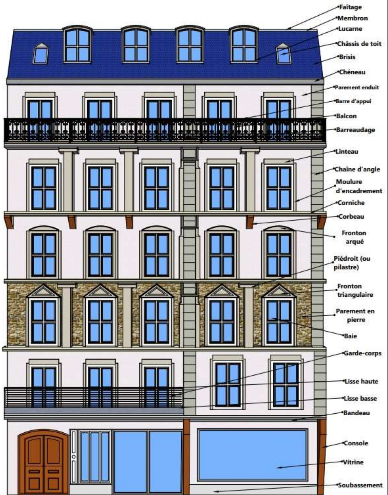
Fig. 14. Lexique de l'architecture d'une façade
