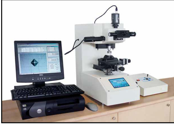
الشكل 13.III: جهاز قياس الصلادة فيكرز نوع "AFFRI" (مختبر العناصر النشطة والمواد بجامعة
