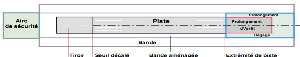
Figure 1.5 : la Tiroir, La bande aménagée et La bande dégagée, L'aire de sécurité
