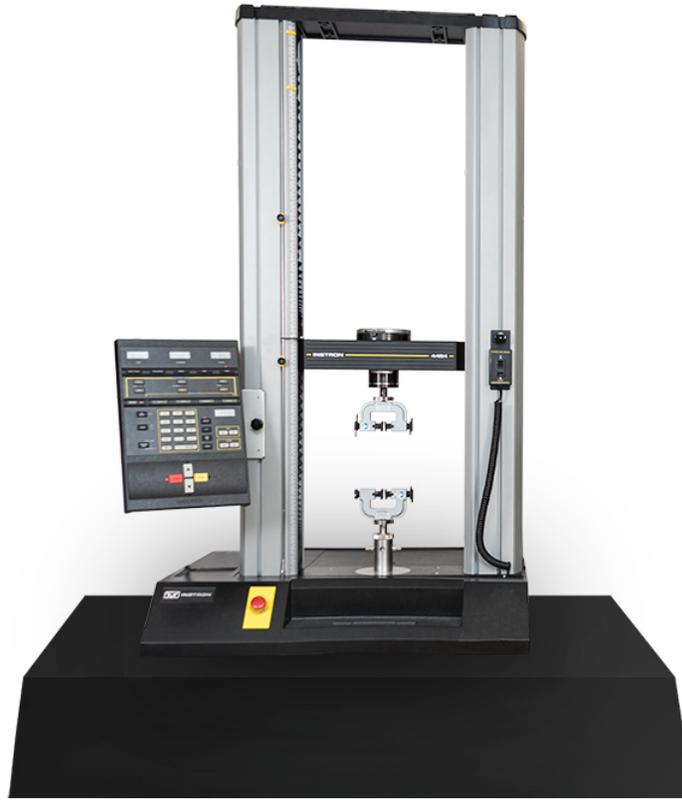
FIGURE 2.4 – la machine instron 4466.
