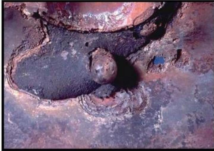
**Figure (I.7) :** Corrosion galvanique au niveau d'une zone de brasage entre la brasure Cu-P et le tube en cuivre
