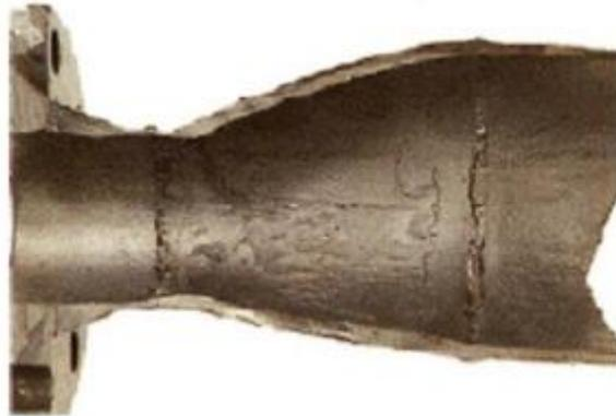
**Figure (I.12) :** Corrosion-érosion dans une zone turbulente
