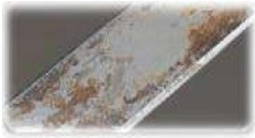
**Figure (I.16) :** la corrosion par frottement
