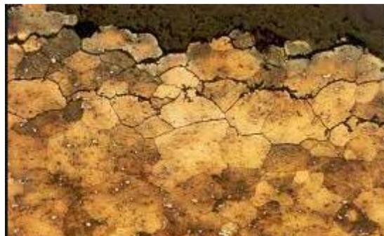
Figure (I.11) : Corrosion sous contrainte.
