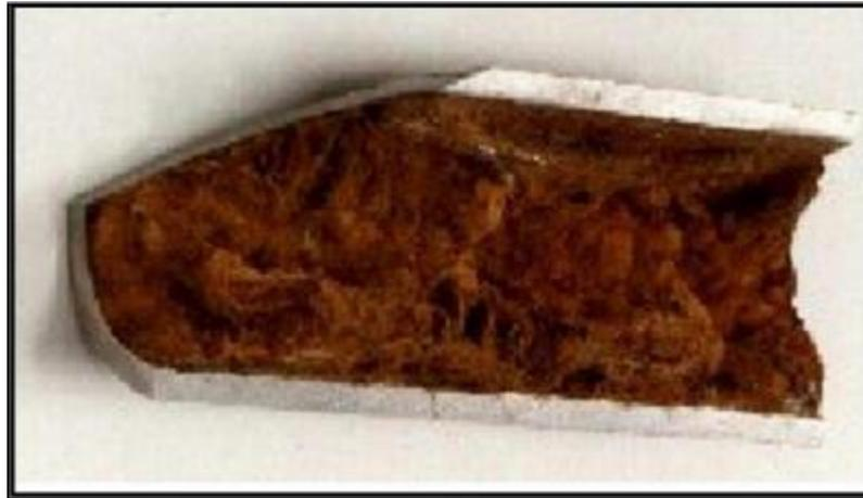
**Figure (I.18) :** Corrosion causé par bactérie.
