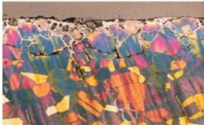
Figure (I.10) : Corrosion inter granulaire d'un inox par hydro chlorure.
