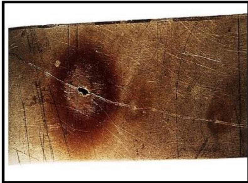
**Figure (I.8) :** Corrosion par piqûres sur la paroi d'une cuve en acier inoxydable austénitique Cr18-Ni10
