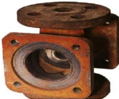
**Figure (I. 5) : Corrosion généralisé (rouille) d'une pièce en acier**
