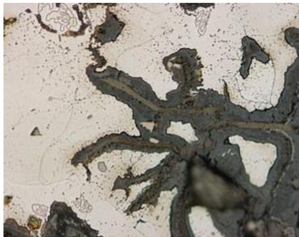
**Figure (I.13) :** Corrosion sélective
