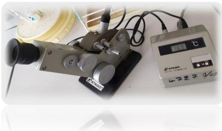
**Fig07** : Refractomètre d'Abbe avec contrôleur de température.
