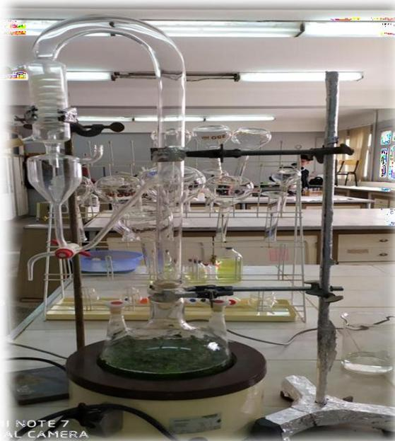
**Fig06 : Hydrodistillateur de type Clevenger.**
